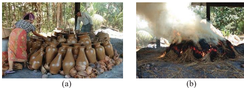
Gambar 3.1. (a) Proses Penataan Gerabah di atas tungku (b) Proses pembakaran gerabah
